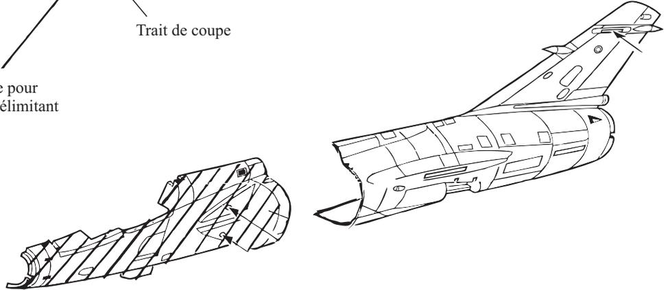
Les entrées d'air sont à fixer en premier sur les demi-fuselages AV de façon à bien filer à l'extérieur pour éviter un masticage trop lourd.
